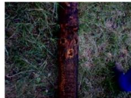
8. kép búvárszivattyú vas-kirakódással
