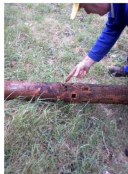
9. kép búvárszivattyú vas-kirakódással
